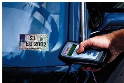
Die auf dem Chip gespeicherten Daten lassen sich mit Hilfe eines Hand-Lesegerätes kontaktlos auslesen.
