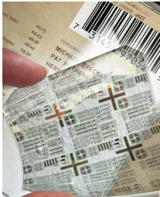
**Infineon integriert erstmals Plastik-Chips auf handelsüblicher Verpackungsfolie. Die Funk-Etiketten benötigen keine Sichtverbindung zum Lesegerät und könnten damit zukünftig Barcodes ersetzen.**
